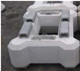
ポーラスコンクリート
